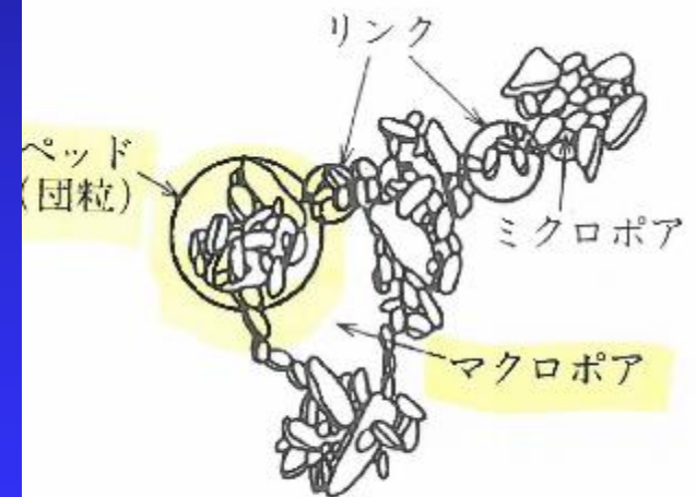
図 1・15 粘土の立体的構造モデル 5)
