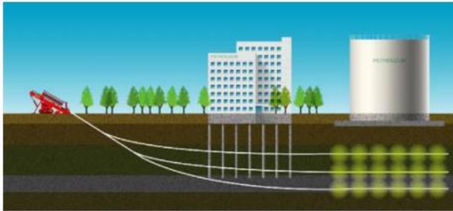
曲線掘孔時 (土圧を利用して上下左右に方向制御)
