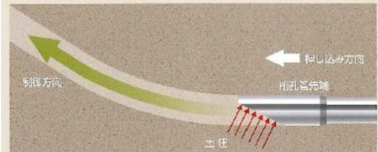
曲線掘孔時 (土圧を利用して上下左右に方向制御)
